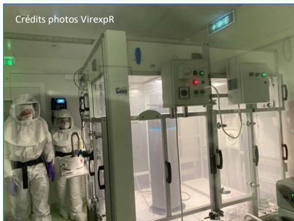
Figure 4. Photos de l'enceinte de nébulisation et de son utilisation pendant l'évaluation du dispositif de traitement d'air SANA (AIRDP) de la prestation EA2202ADP001.1 en laboratoire BSL-3 dans les locaux de VirexpR au Centre d'innovation de Lyonbiopôle. Crédits Photos @VirexpR.
