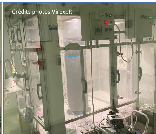
Figure 4. Photos de l'enceinte de nébulisation et de son utilisation pendant l'évaluation du dispositif de traitement d'air SANA (AIRDP) de la prestation EA2202ADP001.1 en laboratoire BSL-3 dans les locaux de VirexpR au Centre d'innovation de Lyonbiopôle. Crédits Photos @VirexpR.
